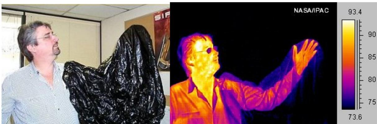
Figura 2.5: Radiação infravermelho emitida pelo corpo humano (direita). Na figura da esquerda a mesma cena registrada com luz visível.
