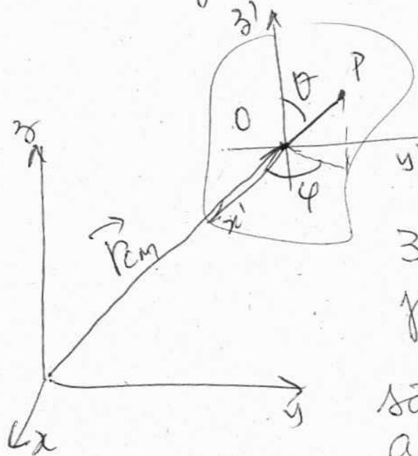
Para se especificar completamente a posição de um corpo rígido no espaço, precisamos de ~~6~~<sup>3</sup> parâmetros:
