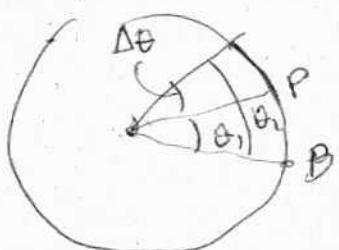
A velocidade angular é dada por  $\omega = \lim_{\Delta t \rightarrow 0} \frac{\Delta \theta}{\Delta t} = \frac{d\theta}{dt}$
