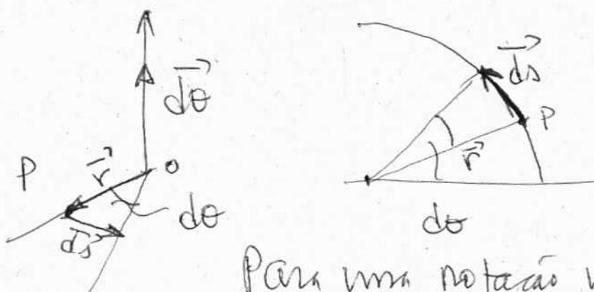
Para uma notação infinitesimal  $\vec{d}\theta$ , o deslocamento  $\vec{ds}$  do ponto P é perpendicular a  $\vec{r}$  e tem módulo  $ds = r d\theta$ . Portanto, podemos escrever:
