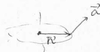
$$\vec{a} = \vec{a}_T + \vec{a}_n = \vec{a} \times \vec{r} + \vec{\omega} \times \vec{v}$$
