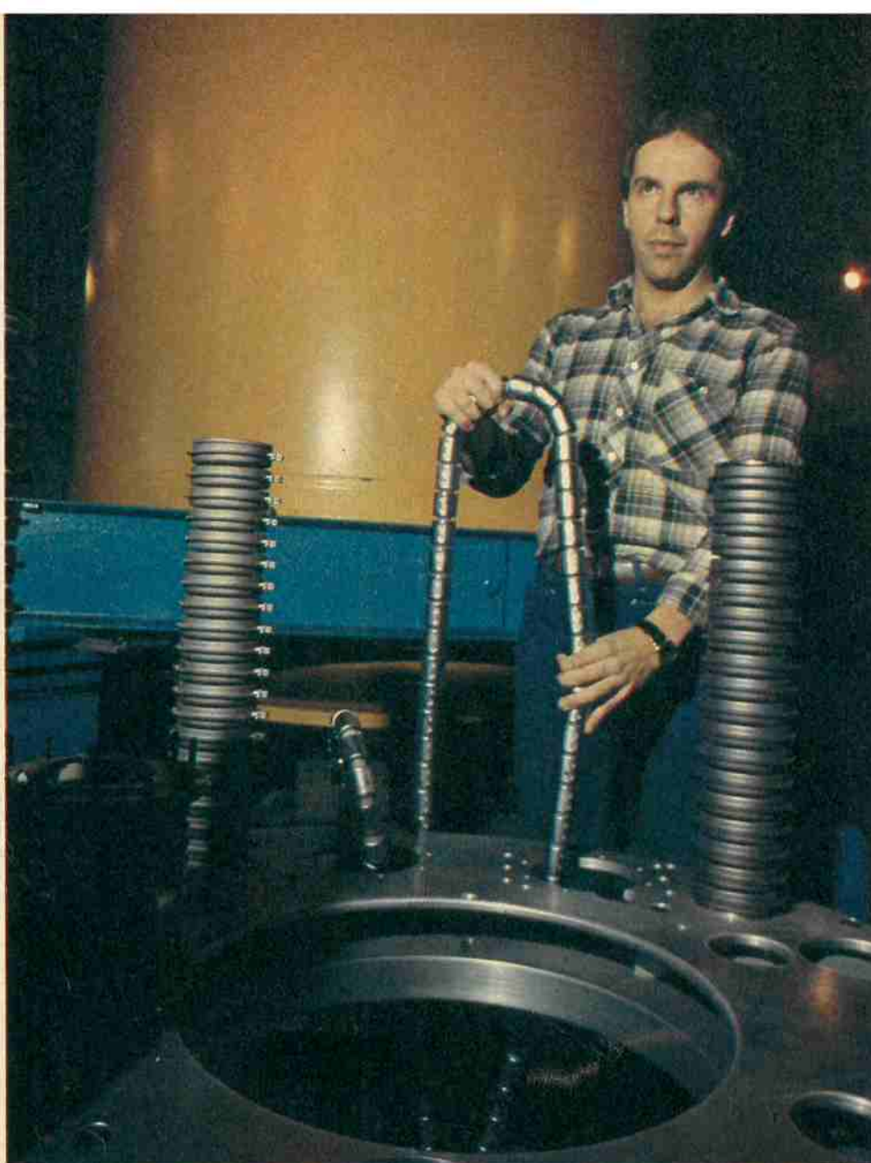
O pesquisador Nelson Carlin Filho com a corrente de pellets que carrega íons positivos.
