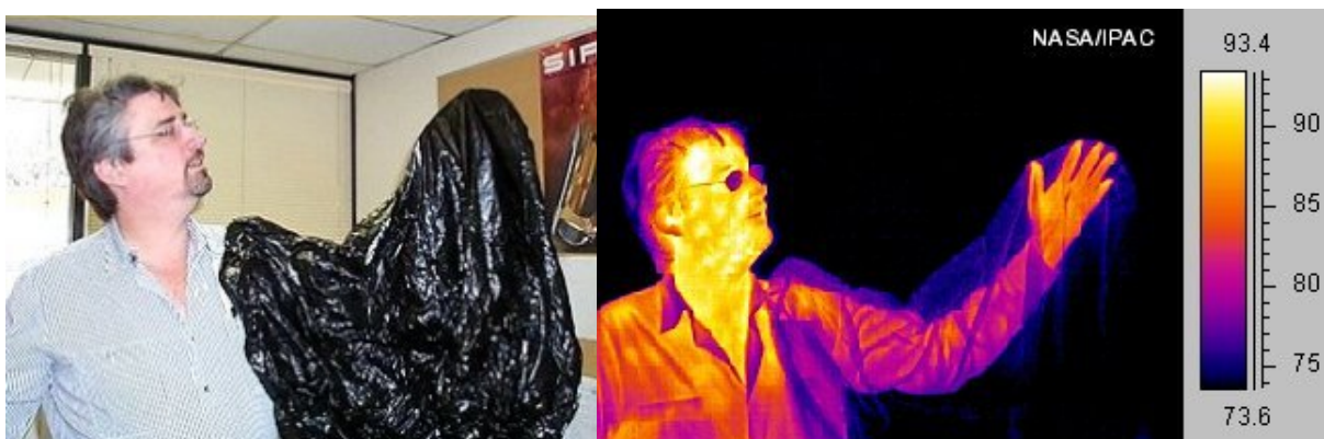
Figura 2.1.5: Radiação infravermelho emitida pelo corpo humano (direita). Na figura da esquerda a mesma cena registrada com luz visível.
